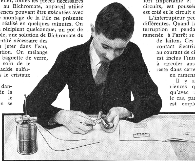
Fig. 4. — Montage d'un électro-aimant en forme de fer à cheval pour une des expériences décrites dans le Manuel Elektron. La tige de zinc de la pile au bichromate de potassium ne devra pas être plongée dans le liquide jusqu'au commencement de l'expérience.
