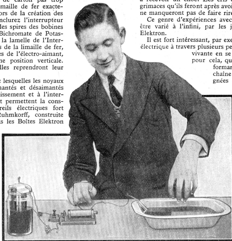
Fig. 2. Il est pratiquement impossible à quiconque tenant une des poignées de la Bobine de Ruhmkorff en main de retirer une pièce de monnaie d'une cuvette remplie d'eau, si la deuxième poignée de la Bobine est plongée dans l'eau. L'action du courant paralyse les muscles de la main et empêche de s'emparer de la pièce de monnaie.
