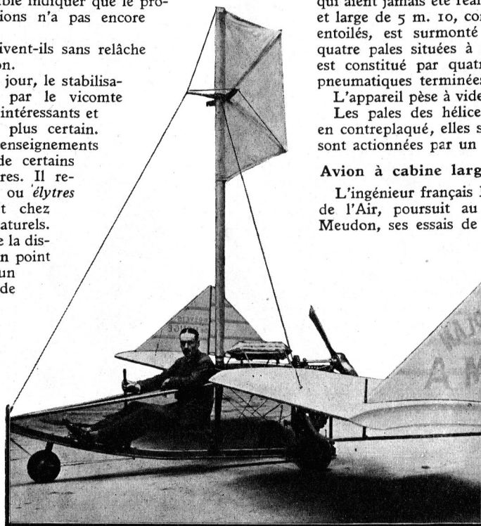
Le vicomte de Rougé à son poste de pilotage dans son nouveau avion sans queue à stabilisateur "Élytroplan".
