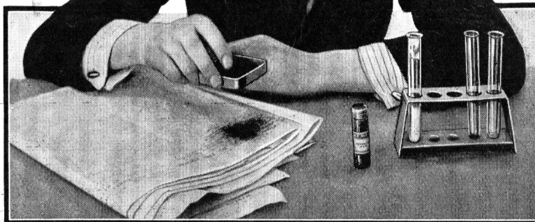
Jeune détective au travail. L'empreinte digitale devient visible grâce à l'emploi d'un mélange de Soufre et de Charbon de Bois en poudre.
