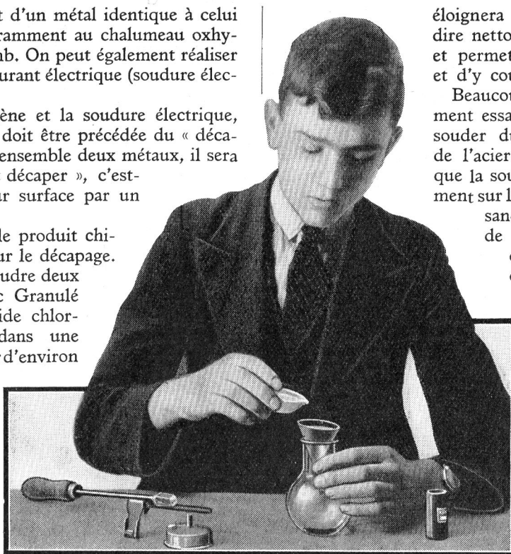
Fig. 2. — Filtrage de la solution obtenue par la dissolution du Zinc Granulé dans de l'acide chlorhydrique dilué. La solution de chlorure de zinc préparée ainsi sert à décaper les métaux pour le soudage.
