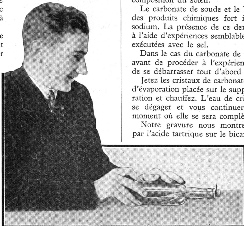
La bouteille-pistolet... L'effet amusant produit par l'acide tartrique sur le bicarbonate de soude.
