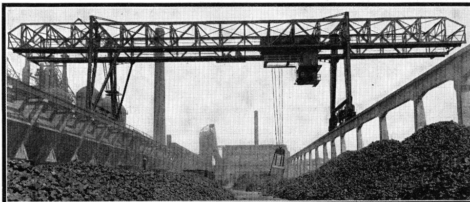
Dans notre numéro de décembre, nous avons donné la description de divers appareils de manutention mécanique, notamment de différents types de ponts roulants et grues à portique. Voici une vue d'un portique roulant géant servant à la manutention de minerai de fer aux aciéries de Corby (Angleterre).
