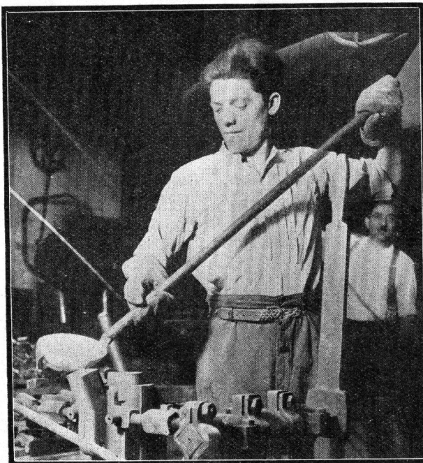
Le moulage du piston. Les photographies que nous reproduisons, prises aux Etablissements « Alsia », à Strasbourg, nous ont été confiées par la revue L'Action Automobile .
