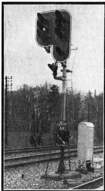
Ci-dessus : le tableau des manettes de la gare de Montgeron-Crosne, surmonté du tableau schématique. A gauche : signal d'entrée de gare (servant au cantonnement automatique des trains et à la protection des manœuvres ; derrière ce signal, l'armoire à relais (représentée ouverte en haut, à droite).
