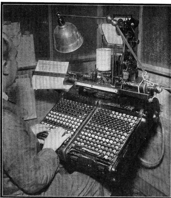
Machine clavier Monotype. Les photos que nous reproduisons ont été prises à la Société Industrielle D'Imprimerie, chargée de l'impression du "Meccano Magazine".
