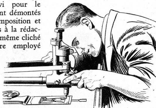
Fig. 4. — La plaque de zinc du cliché terminée, on en élimine au moyen d'une machine spéciale à outil coupant l'excédent de métal resté entre les traits du dessin.
