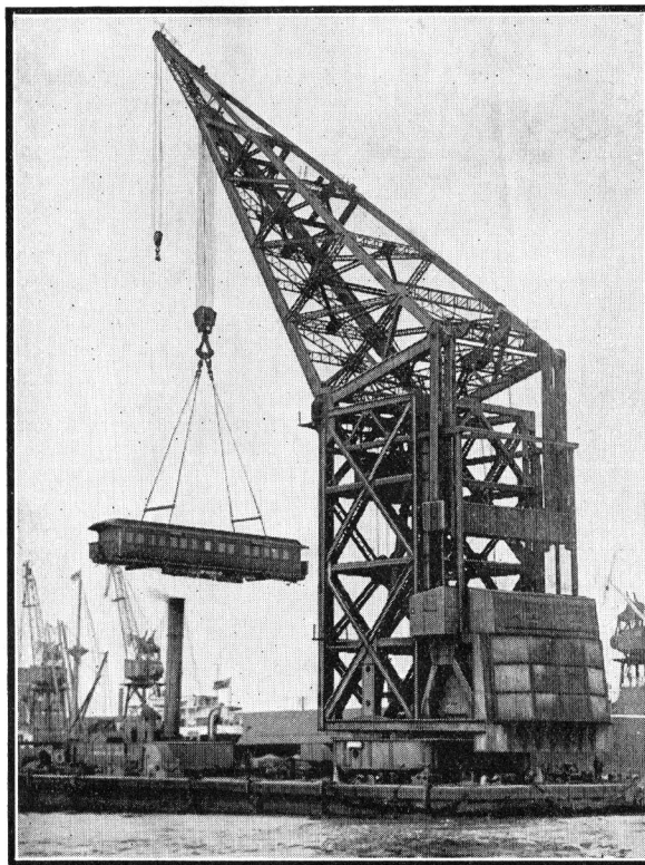
La grue flottante Mammouth , de Londres (puissance 150 tonnes), occupée à charger sur un navire des voitures de chemin de fer destinées à l'Afrique australe britannique. - Photo de l'administration du Port de Londres.
