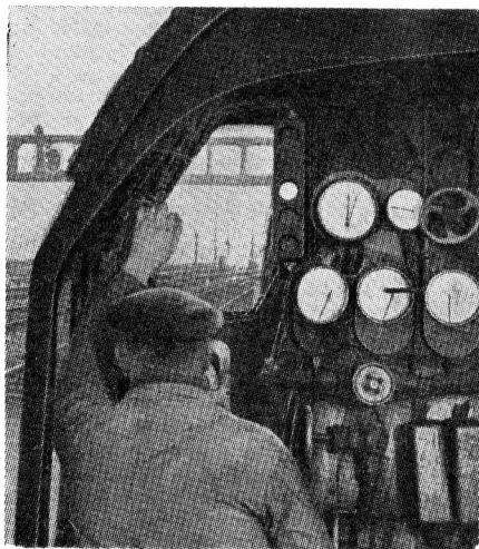
Répétition du signal commandant le canton dans l'abri du mécanicien (à gauche des manomètres). Ce système, appelé « cab-signal », n'est utilisé que sur quelques lignes.
