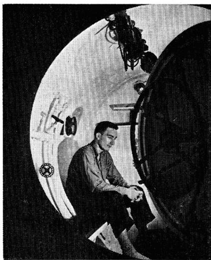
Un élève vient de prendre place dans la « chambre de pression » ; les tests subits dans ce caisson permettent de connaître les réactions des futurs scaphandriers aux brusques chutes de pression.
