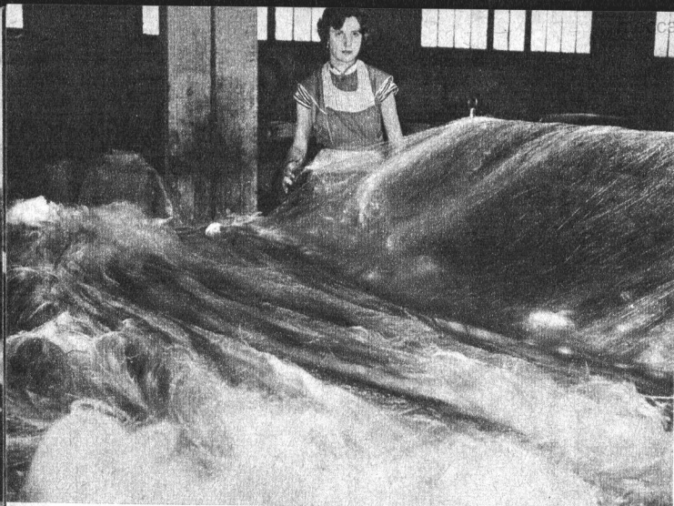
● Atelier Fibres de verre de la firme Boussois. Les échevaux sont défilés avant d'être plongés dans une solution de formol et d'amidon.
