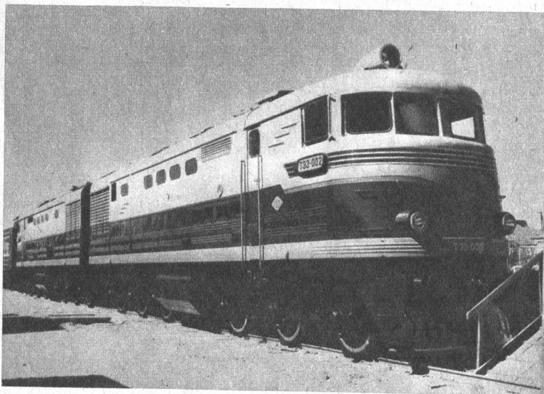
Locomotive diesel de série « TE 3 », construite par l'usine de Kharkov ; « TE-3 » pour convois de marchandise lourde, « TE-7 » pour trains de voyageurs. Puissance 4.600 CV. Remorque un convoi de 1.000 tonnes à 140 kilomètres-heure.
