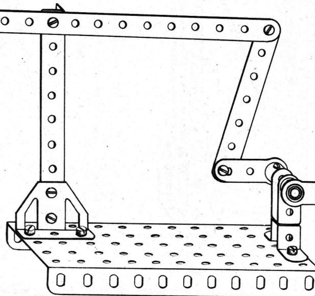
Esempio di trasformazione del moto rotativo in moto alternativo verticale.
