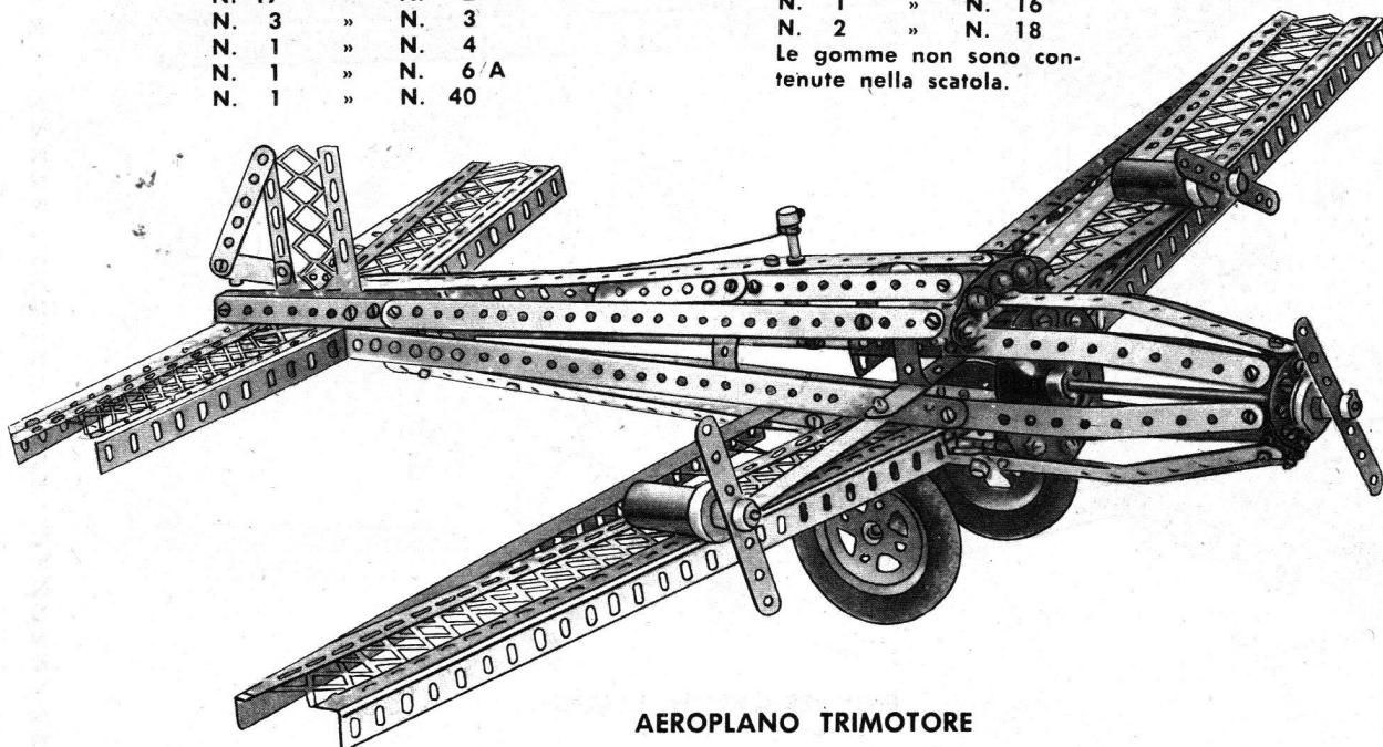
**SI COSTRUISCONO CON LA SCATOLA N. 6 OPPURE 5 E 5/A****On construit avec la boîte N. 6 ou 5 et 5/A****Metall - Baukasten 6 - 5 - 5/A**
