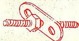
Соединение двух планок при помощи третьей называется «связкой встык».
