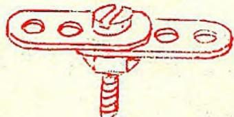
Если нужно закрепить деталь на резьбовом стержне, применяются две гайки, которыми плотно свинчивают деталь с двух сторон.
