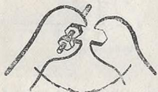
Для того, чтобы гайка не отвернулась, закрепить ее второй гайкой.
