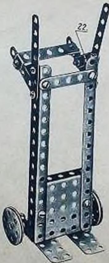
Такую тачку называют «медведкой», т. к. с её помощью производят погрузку больших тяжестей. Она представляет собой рычаг с опорой на колёсах. Длинное плечо рычага — рама тачки, а короткое — лапки. Лапки тачки подводят под груз, затем наклоняют раму назад, и тачка оказывается нагруженной.
