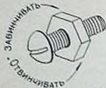
Детали скрепляются винтами с гайками. Завинчивание винта, закрутка гайки производится по часовой стрелке: сверху — вправо — вниз.
