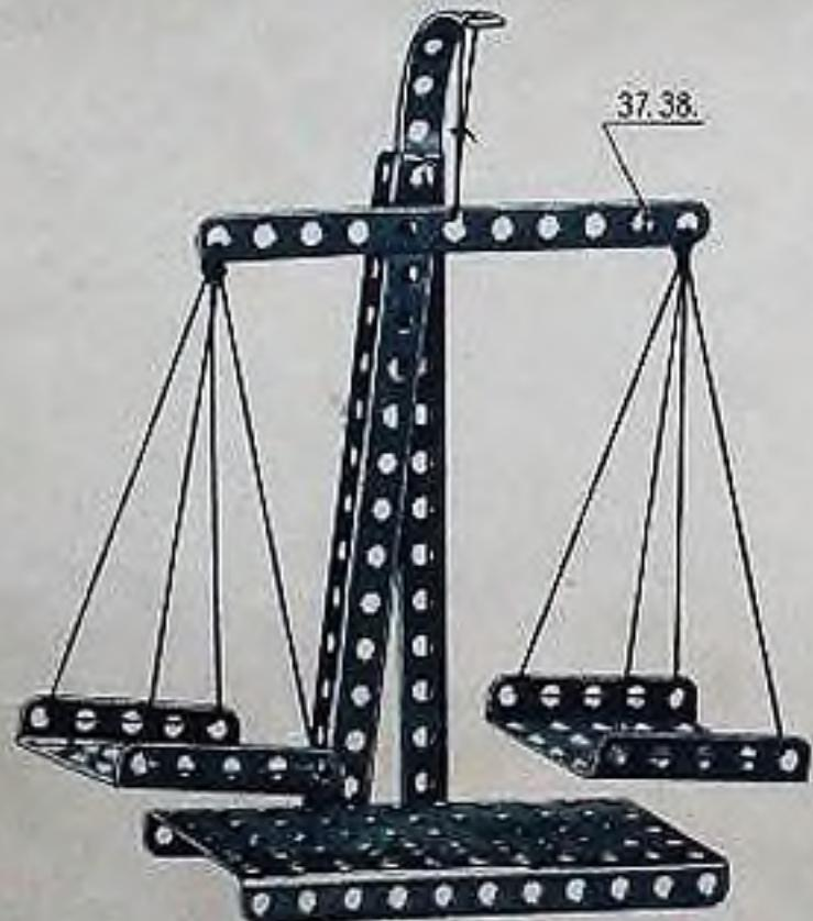
Перед нами модель весов с равноклещим рычагом — коромыслом. Оно подвешено к стойке и качается на шнуре. Тарелка весов подвешивается на одном куске шнура длиною 80 см.
