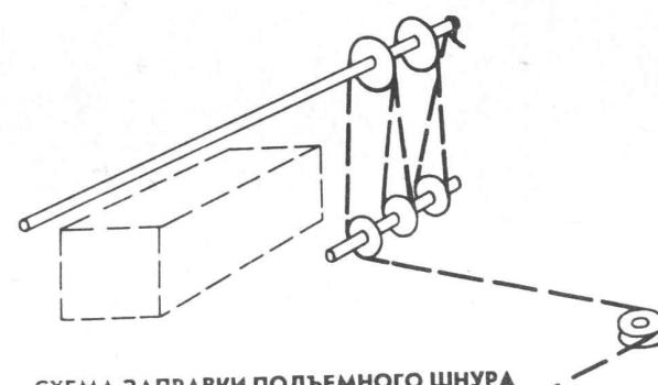
СХЕМА ЗАПРАВКИ ПОДЪЕМНОГО ШНУРА
