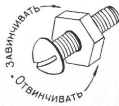
Детали скрепляются винтами и гайками. Завинчивание винта, завертывание гайки производится по ходу стрелок часов: сверху — вправо — вниз.
