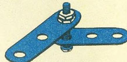
Чтобы получить надежное подвижное соединение деталей, необходимо оставить на винте зазор между деталями и применить контргайку.
