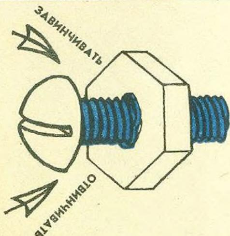
Завинчивание винта или завертывание гайки производится в направлении по ходу стрелок часов, сверху—вправо—вниз.
