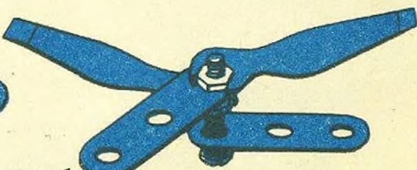
В наших моделях часто применяется такое соединение. Одна из соединяемых деталей туго зажимается между двух гаек на конце винта.
