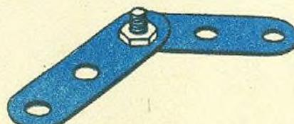
Один винт с гайкой не может надежно скрепить детали. От сотрясений гайка отвертывается, детали расходятся.
