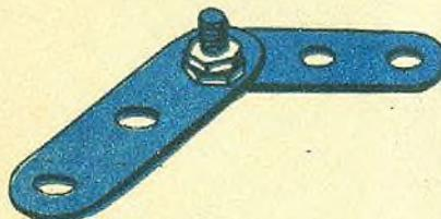
Вторая гайка, туго притянутая к первой, не позволяет винту развинчиваться. Эту вторую гайку называют контргайкой.
