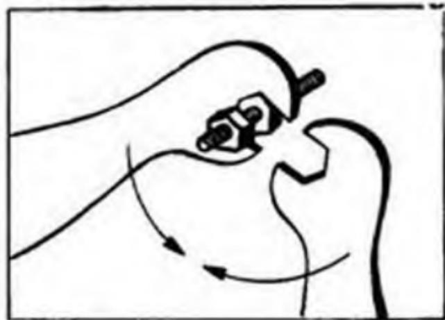
Для того, чтобы гайка не отвернулась, закрепи ее второй гайкой.
