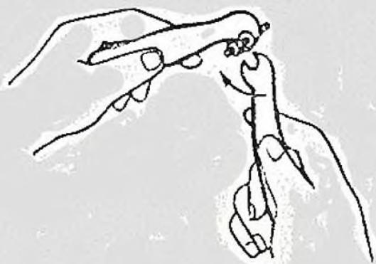
Если понадобится закрепить гайку на определенном месте, держи ее ключом и закрепляй встречной гайкой
