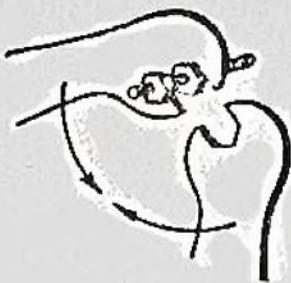
Для того, чтобы гайка не отвернулась, закрепи ее второй гайкой
