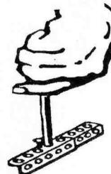
Чтобы легче прошёл винт в отверстия соединяемых деталей, можно использовать отвёртку, вставляя её в соседнее отверстие этих деталей.
