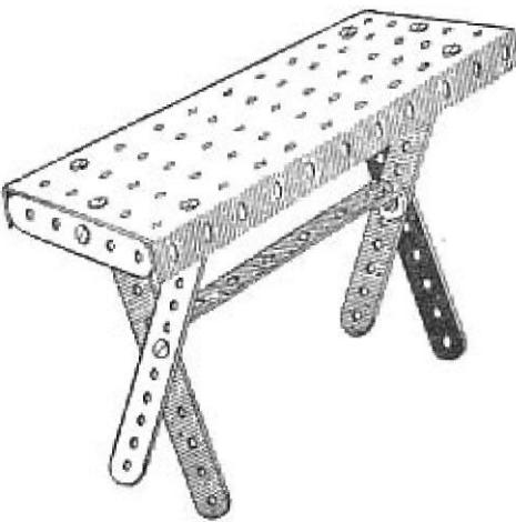
Die große Platte A 11 und zwei Lochbänder A 5 bilden die Tischplatte. Als Tischbeine werden Lochbänder A 2 verwandt, die am Kreuzpunkt durch ein Lochband A 3 mittels Winkel A 9 verstrebten werden.
